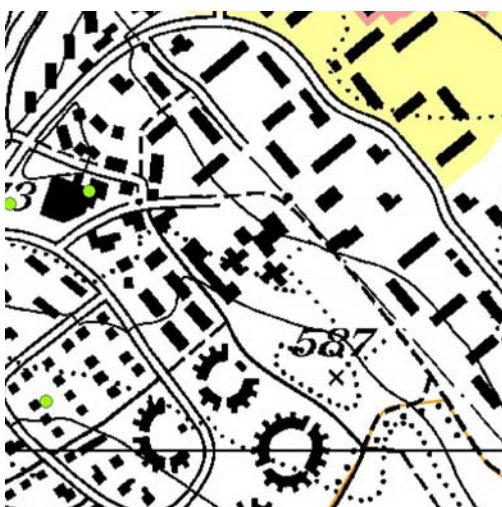
Fig. 6: Auszug aus Wärmenutzungsatlas des Kantons Zürich mit Zonen der Grundwassernutzung (Grüne Flächen) und heute vorhandenen Erdsonden (grüne Kreise). In den weissen Zonen ist eine Erdwärme- oder Grundwasserwärme grundsätzlich möglich, in den türkisblauen Zonen unter Auflagen.
